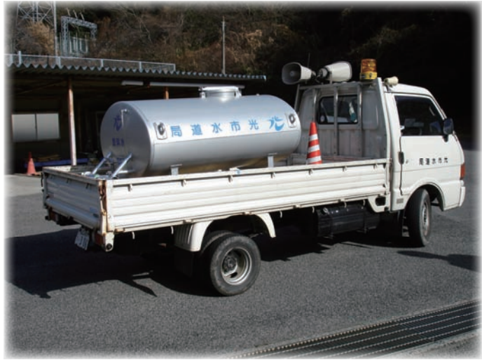
▲光市水道局所有の車載用給水タンク
