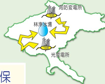
停電による林浄水場の機能停止のリスクを低減するため、周防変電所と光変電所の2か所からの受電を行っています。
