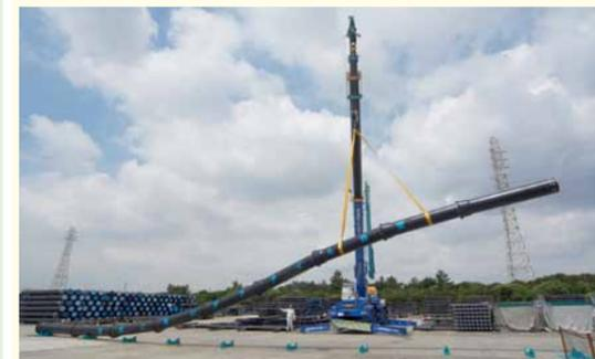
耐震管の性能試験の様子
